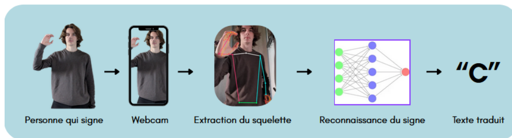
Figure 2.2 – Principe général de HearMyHands : acquisition par webcam, extraction des points clés, traduction par le Modèle 2 puis affichage du texte reconnu.
